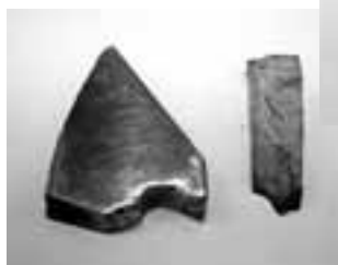
← 損傷した破碎機の刃。多額の修理費がかかりました。
