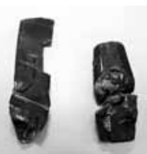
← 損傷した破碎機の刃。多額の修理費がかかりました。
