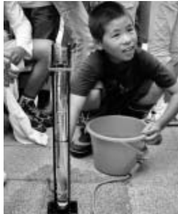
透視度計で、御祓川の透明度を計ります。結果は、36cm!!御祓川は汚れているんだね。
