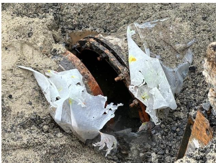
配水管が地震で被害を受け、継ぎ目が脱落しました。
