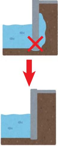
問題の地点では、県道田尻祖母ヶ浦半浦線沿いの土地が沈下してきており、護岸壁も落ち込み、水門にも影響が出てきています。
